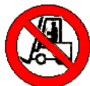
Vietato ai carrelli di movimentazione
